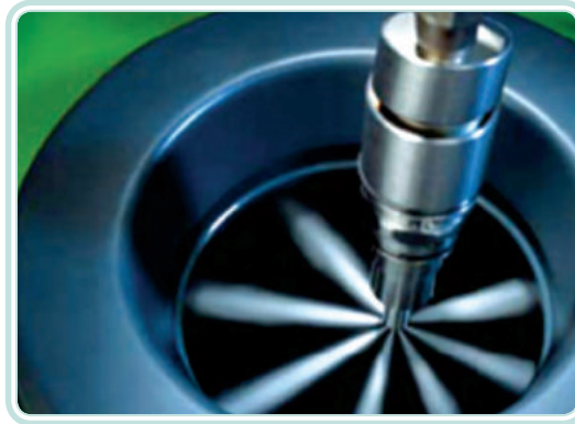
Figura 4.24: Ação do bico injetor
