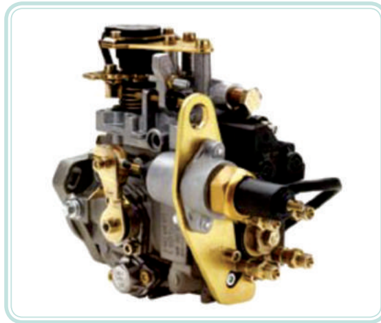
Figura 4.22: Bomba distribuidora rotativa
