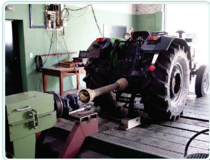
Figura 8.2: Trator agrícola acoplado ao dinamômetro
