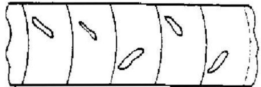
Porosidade alinhada – Conjunto de poros dispostos em linha, segundo uma direção paralela ao eixo longitudinal da solda
