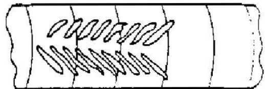
Porosidade vermiforme – Conjunto de poros alongados ou em forma de espinha de peixe situados na zona fundida
