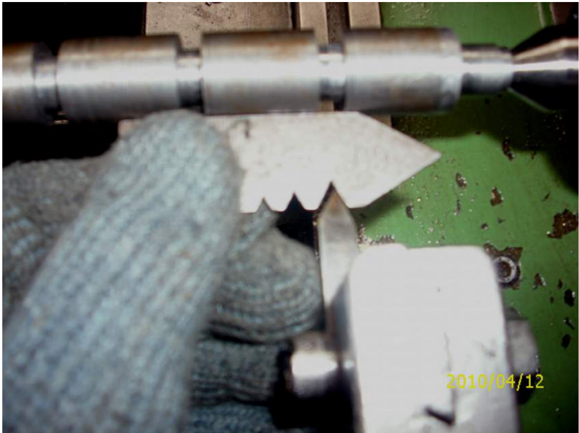
Ajuste da perpendicularidade da ferramenta em relação a peça.
