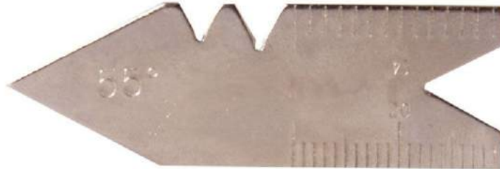
Escantilhão de 55º para rosca triangular whitworth.
